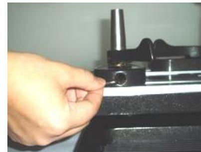
Drehen Sie das Zangenunterteil so, dass es im rechten Winkel zur Schiene steht. Nehmen Sie nun den 3.0 mm Inbusschlüssel und stecken Sie diesen in die innere Einstellschraube. Drehen Sie den Inbusschlüssel nach rechts um die Spannung zu erhöhen. Die ideale Feststellposition für den Hebel sollte unter der Mitte des Zangenunterteils sein.
