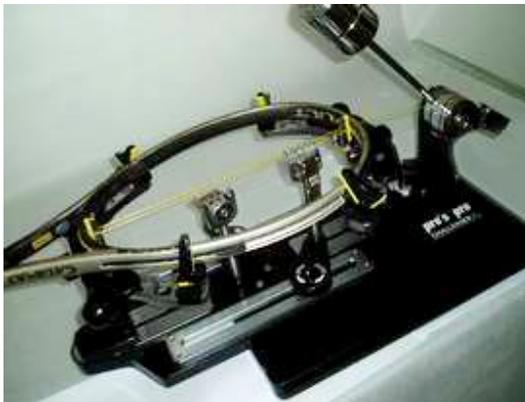
2. Mittels der Feststellschrauben der Stützen und den Feinverstellungsschrauben des Auflagearms wird das Racket nun die in gewünschte Positionen gebracht. Das Racket muss von den Rahmenfixierungen und den Herz-Kopffixierungen umschlossen werden. ACHTUNG! Wenden Sie dabei nicht zu viel Kraft an, was das Racket beschädigen könnte!
