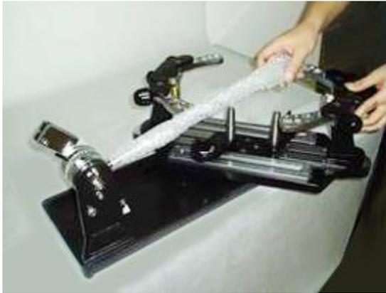
4. Stecken Sie die Gewichtfeststellschraube in das vorgesehene Loch im Gewicht. Achtung! Falls Sie Squash- oder Badmintonschläger besaiten, müssen Sie das Gewicht teilen. Es darf nur der obere Teil (siehe Abbildung) auf dem Hebelarm geschoben werden.
