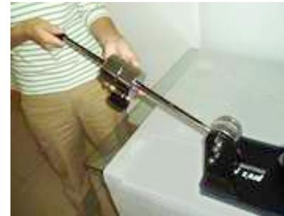
6. Nehmen Sie nun den 5.0 mm Inbusschlüssel um den Hebel in der entsprechenden Position zu fixieren.
