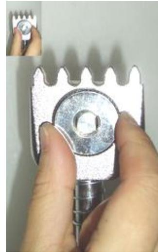
Um die Zange festzuziehen drehen Sie wie abgebildet den Knopf nach rechts. Um sie zu lockern, drehen Sie den Knopf nach links.
