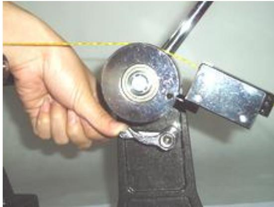
4. Nachdem Sie den Hebel in horizontale Positionen gebracht haben, wird an der Saite mit dem eingestellten Gewicht gezogen. Sichern Sie nun die Saite mit den Haltezangen. Drücken Sie danach den Bügel nach unten und richten Sie den Hebel wieder nach oben damit am Schnellspanner der Zug an der Saite wieder freigegeben wird. **ACHTUNG!** Wenn Sie den Bügel nicht nach unten drücken ist es unmöglich den Saitenzug freizugeben.
